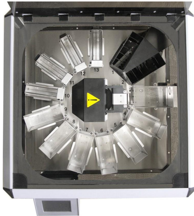
Рисунок 4. Рабочая камера автомата с установленными принадлежностями (поддонами, ваннами и штативами).
