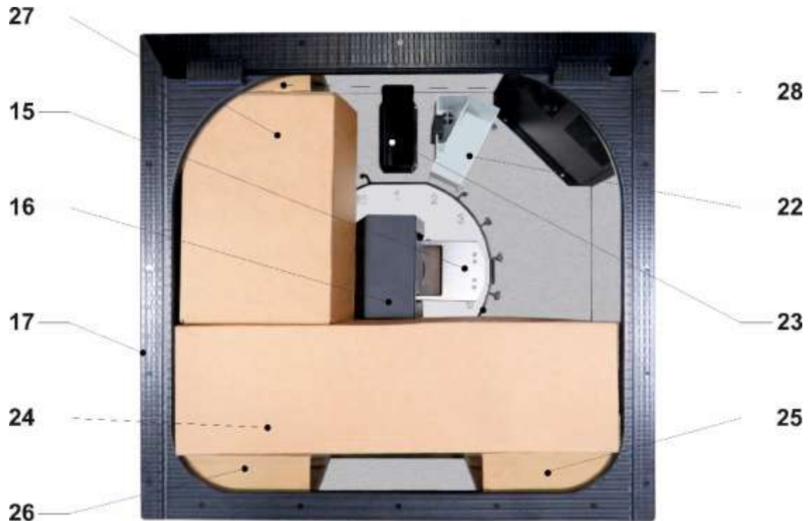
Рисунок 6. Распаковка прибора. Вид на рабочую камеру при открытой крышке 15 – рука манипулятора; 16 – кожух манипулятора; 17 – верхняя панель прибора; 22 – станция промывки (с проточной ванной); 23 – станция сушки; 24 – коробка с принадлежностями (ванны с крышками, штативы); 27 – дополнительная коробка с принадлежностями; 25,26,28 – прокладки.
