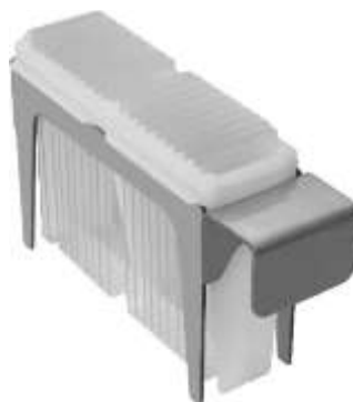
Рисунок 5. Штатив-вкладыш ШВВ-20 и штатив держатель ШД-20 в сборе Прибор комплектуется тремя типами ванн:
