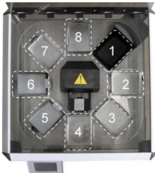
Рисунок 4. Рабочая камера прибора с установленными принадлежностями (поддонами, ваннами и штативами).
